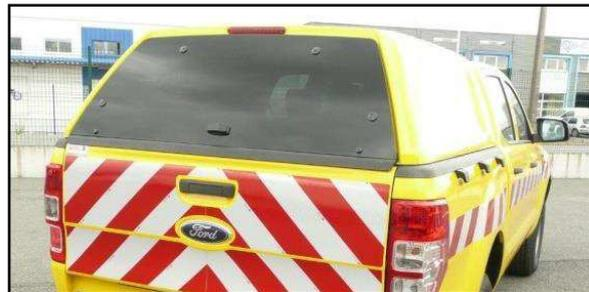
**DE SERIE** : Hayon vitré - teinté dans la masse, poignée centrale avec fermeture à clefs
